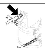
**2**Connect the air hose to the gun. 將空氣軟管連接到噴槍上。 ガンにエアホースを接続します。 ブ 에 에 어 호 스 를 연 결 합 니 다.
